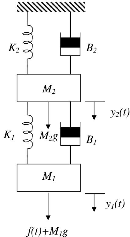
**Objetivo:** Determinar la respuesta dinámica del desplazamiento vertical de la masa  $M_1$ ,  $y_1(t)$ , o de la masa  $M_2$ ,  $y_2(t)$ , ante una variación de  $f(t)$ .
